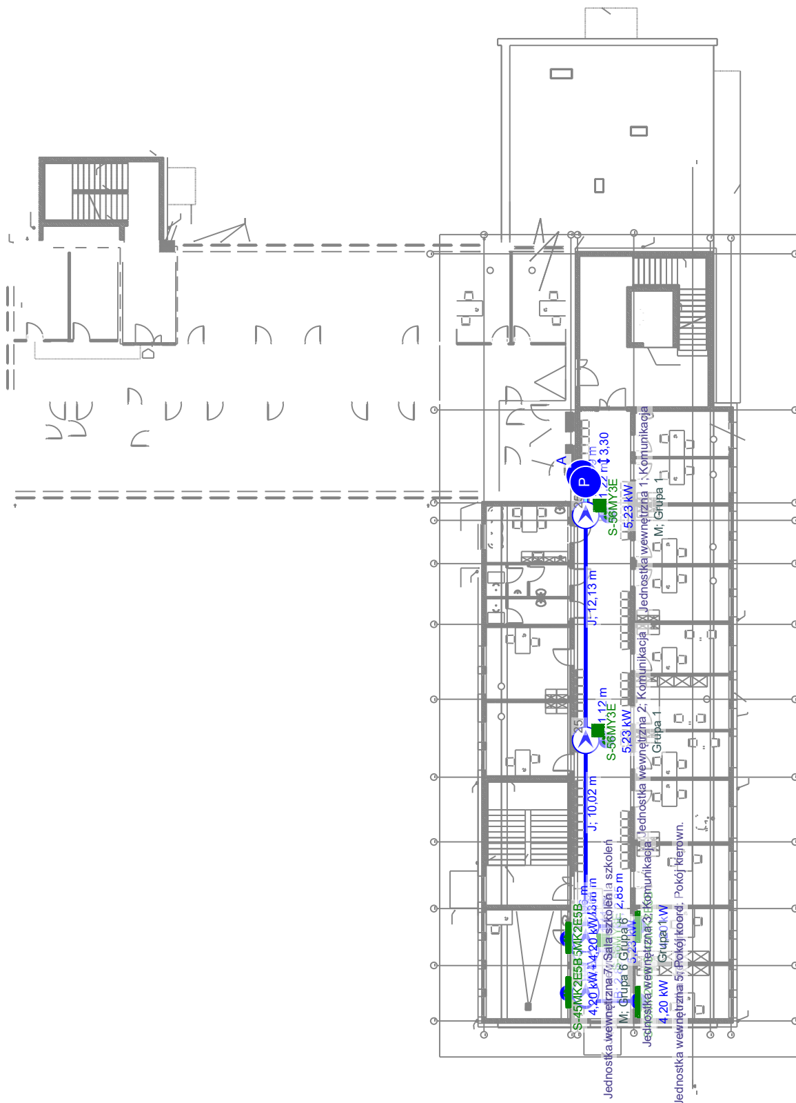
Schemat montażu orurowania - I piętro (1 piętro) - System 5
